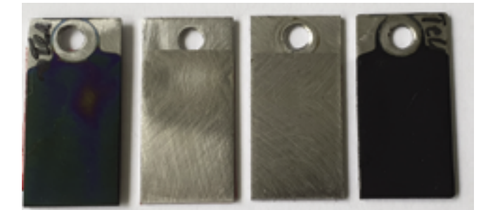
Makroaufnahmen von iridiumoxidbeschichteten Blechen.
