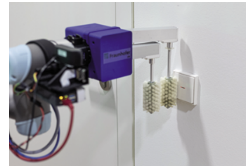
Mit seinen Reinigungsbürsten entfernt DeKonBot 2 groben Schmutz an der Türklinke und trägt gleichzeitig flächendeckend Desinfektionsmittel auf.
